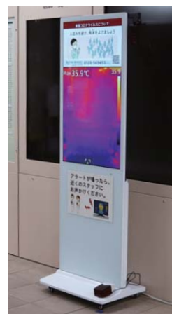
附属病院外来入口に設置された サーマルカメラ
