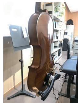
左：XR によるオーディオビジュアル作品《Encounters》中川隆研究室 右上：Los Angeles における映像制作短期研修の様子 栗原研究室 中：CG と HMD による人体の幾何学的抽象化《キュービック体操》小鷹研究室 右：振動装置と MAX 制御による拡張楽器「ハイブリッド・ヴァイオリン」松宮研究室
